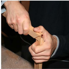
Zusammenstecken der Leisten Press the stretcher elements... Mettez les bords, comme ...
