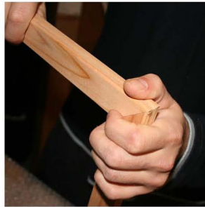
Nut & Feder müssen ineinander with tongue and groove together l'un dans l'autre sur l'illustration.
