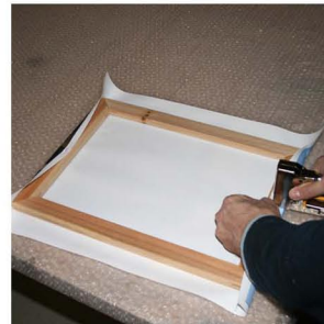
anschl. gegenüberliegende Seite ... then fix the opposite side ... puis de fixer le côté opposé
